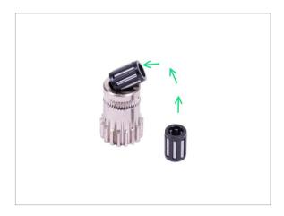
Legen Sie beide Kugellager in die Riemenscheibe ein. Achten Sie darauf, dass die Kugellager während dem Einsetzen nicht herausfallen.
