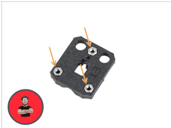
● Inserta tres tuercas M3n en las aberturas con forma de la heatbed-cable-cover-bottom.
