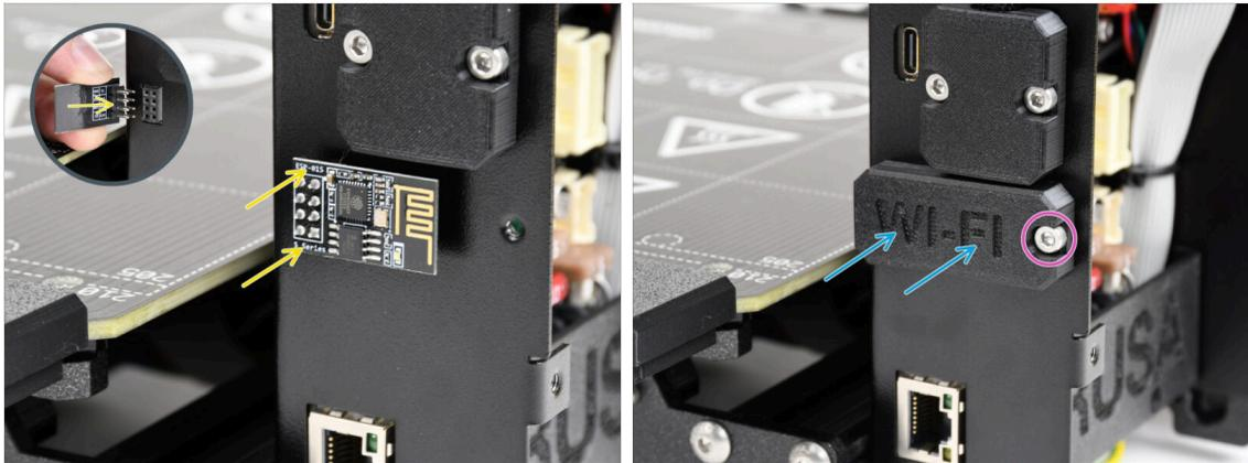
⚠ **Fai molta attenzione** quando maneggi e colleghi il modulo ESP in modo da **evitare di piegare e danneggiare i pin.**
