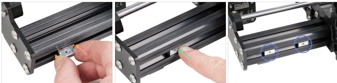
● Inserisci il dado M3nEs nell'estrusione corta sinistra (lato senza PSU). Inserisci prima il lato con la molla (piastra metallica).
