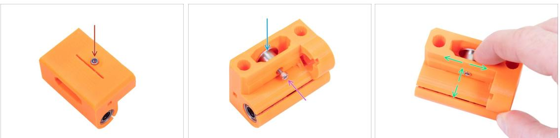
**△ 注意:** 締め込む際には、ナットの向きを確かめ、細心の注意を払って作業を行ってください。部品を壊してしまう可能性があるため、無理な力は加えないでください。
