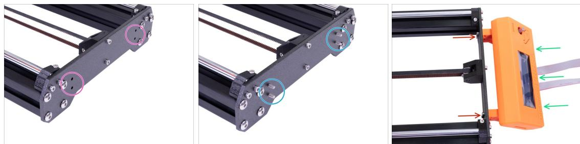
⚠ 注意!!! このステップで、プリンターの前面に LCD が取り付けられます。まだ制振材を取り付けていない場合は、いま取り付けてしまってください。後ほど組み付けるのであれば、LCD ホルダーにダメージを与えないよう、充分に気を付けて作業を行ってください。制振材の組み付け方は、第2章をご確認ください
