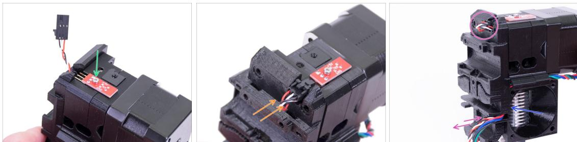
● Placez le capteur IR sur le dessus de l'Extruder-body et fixez-le avec la vis M2x8. **Assurez-vous que la pièce en plastique noir en forme de "U" est orientée vers le bas.**
