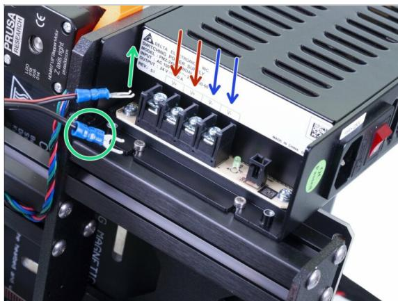
**⚠ POZOR: Několikrát zkонтrolujte, zda jste správně připojili kabely!!** V případě, že jsou kabely nesprávně zapojené nebo nejsou správně dotaženy, je zde riziko poškození zdroje nebo samotné tiskárny.
